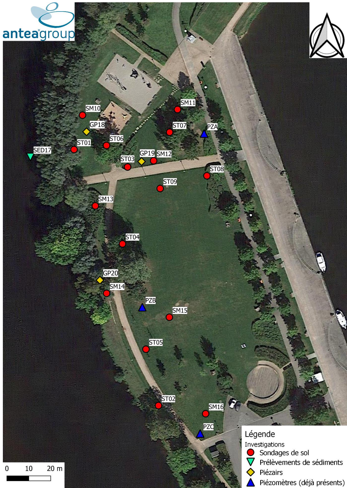
Figure 9 : localisation des investigations réalisées - état existant
