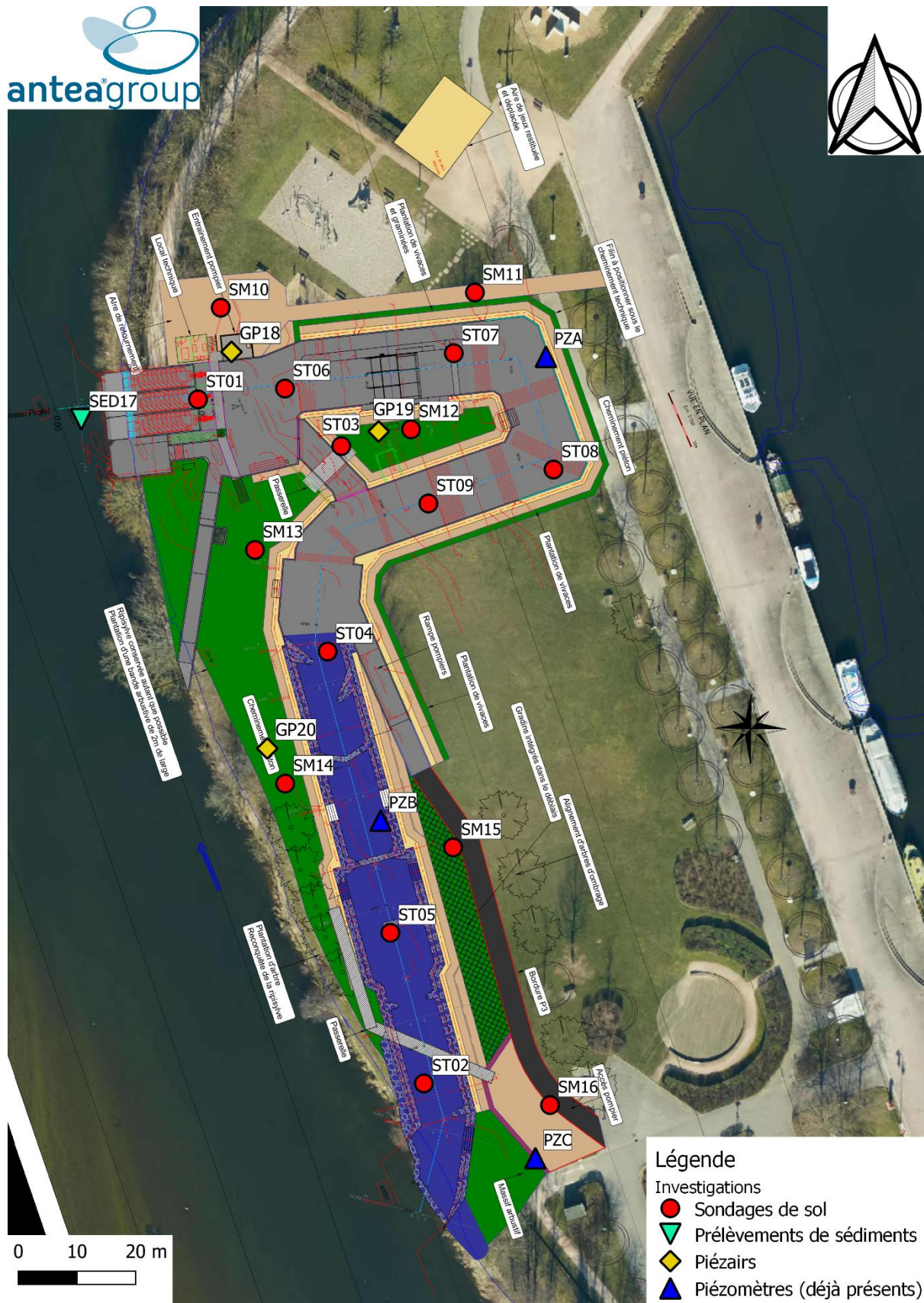
Figure 10 : localisation des investigations réalisées - état projeté
